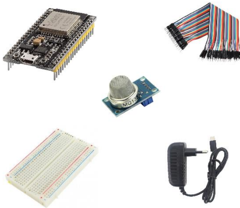
Gambar 1. Komponen Utama Sistem Monitoring: Modul ESP32, Sensor MQ135, Breadboard, Kabel Jumper, dan Adaptor Daya.
