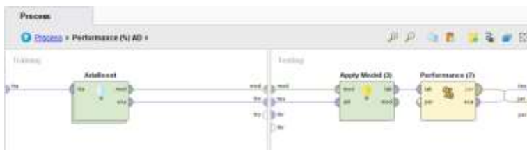
Gambar 4. Proses Training dan Testing pada Cross Validation (AdaBoost + Naïve Bayes)
