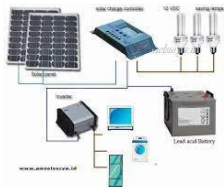
Gambar 1. Skema Rangkaian Pembangkit Listrik Menggunakan Panel Surya
