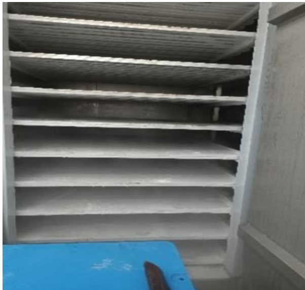
Gambar 6. Kabinet beku yang mempunyai kapasitas 1500 kg
